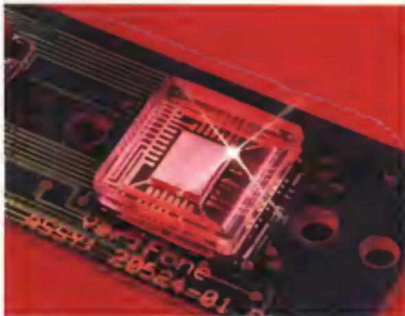
11000 il chip «Ochio Neurale» cura del dottor David Drey che è la prima esplosione commerciale della tecnologia delle reti neurali analogiche su silicio. Con funzioni combinate di sensore di immagini e riconoscimento ottico di caratteri (OCR) in un unico chip 11000 è capace di leggere e riconoscere 7000 caratteri al secondo.
